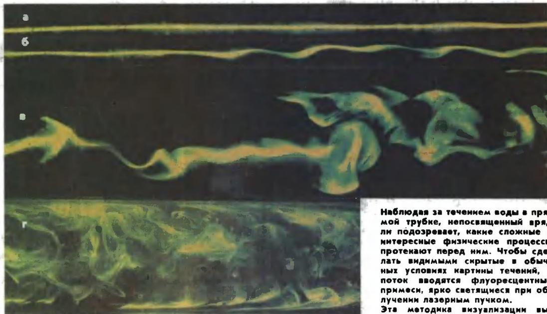
Наблюдая за течением воды в прямой трубке, непосвященный вряд ли подозревает, какие сложные и интересные физические процессы протекают перед ним. Чтобы сделать видимыми скрытые в обычных условиях картины течений, в поток вводятся флуоресцентные примеси, ярко светящиеся при облучении лазерным пучком.
