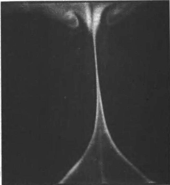
пространственную структуру. Такая модулированная струя при незначительном увеличении скорости легко переходит в турбулентный режим. Это можно использовать для интенсификации процессов тепло- и массообмена в различных технологических аппаратах.
