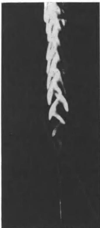
Небольшие механические колебания источника струи или среды, в которой она распространяется, приводят к ее раскачиванию. В результате струя приобретает сложную пространственную структуру [структура, изображенная на фото, получила название «хребет селедки»]. Модулированная струя легко теряет устойчивость и превращается в турбулентную.
