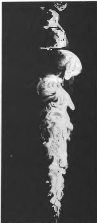
При большой скорости истечения струи она переходит в турбулентный режим движения. Начинается интенсивное беспорядочное перемешивание струи с окружающей жидкостью, и струя быстро распадается.
